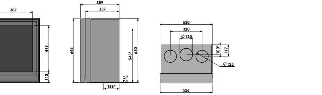
Unilux-6 55 - verdiept kader / insert frame / cadre de profondeur / vertiefter Rahmen
