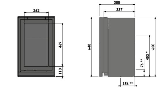
Unilux-6 45 - verdiept kader / insert frame / cadre de profondeur / vertiefter Rahmen
