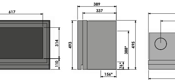
Unilux-6 75 - verdiept kader / insert frame / cadre de profondeur / vertiefter Rahmen
